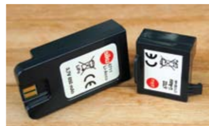
Die unterschiedlich hohen Kapazitäten der Akkus schlagen sich in den Abmessungen nieder
